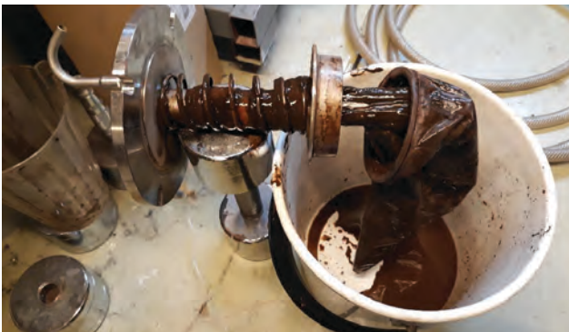
Sivuvirtasuodattimen magneetti ja suodatinpussi ennen pesua osoittavat pesun tarpeellisuuden.
